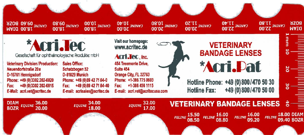
Abb. 2: Mess-Schablone zur Ermittlung der geeigneten Linsengröße.
